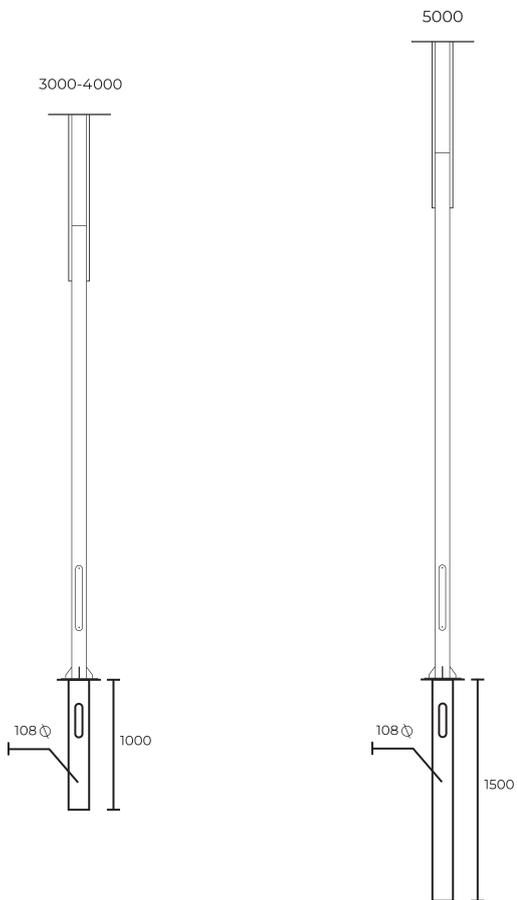
Закладная устанавливается в грунт, в подготовленную яму цилиндрической формы и соответствующей глубины, с соблюдением необходимой ориентации монтажных отверстий. Для фиксации закладной она заливается бетонным раствором.
