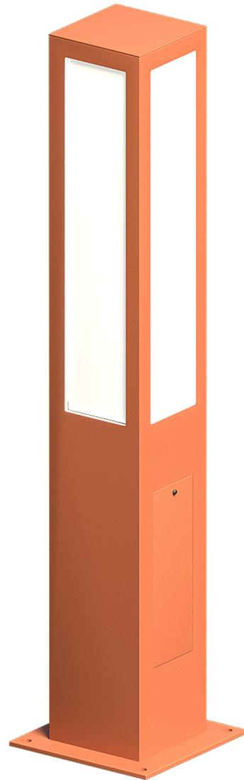
Закладная устанавливается в грунт, в подготовленную яму цилиндрической формы и соответствующей глубины, соблюдая необходимую ориентацию монтажных отверстий. Для фиксации закладной она заливается бетонным раствором.
