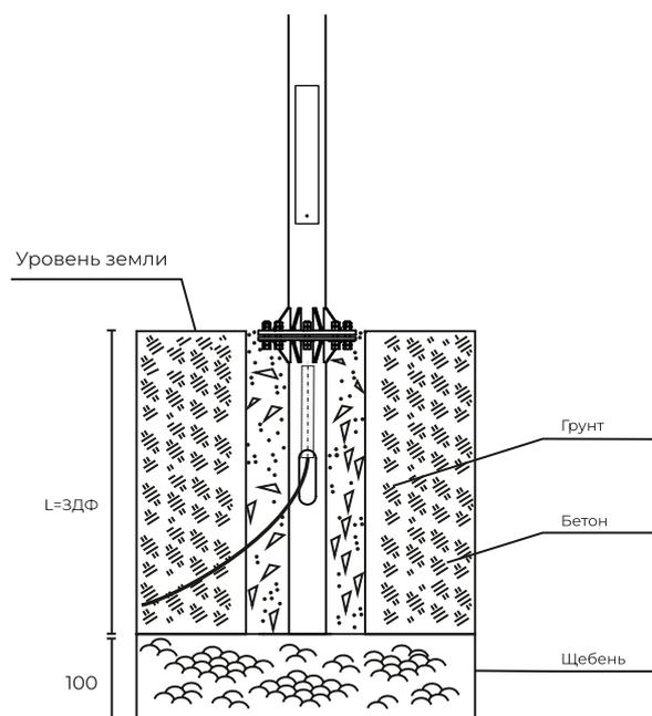
Закладная устанавливается в грунт, в подготовленную яму цилиндрической формы и соответствующей глубины, соблюдая необходимую ориентацию монтажных отверстий. Для фиксации закладной она заливается бетонным раствором.
